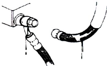
(Χαλάρωση, διαρροή, καταστροφή σωληνώσεων φρένου)
